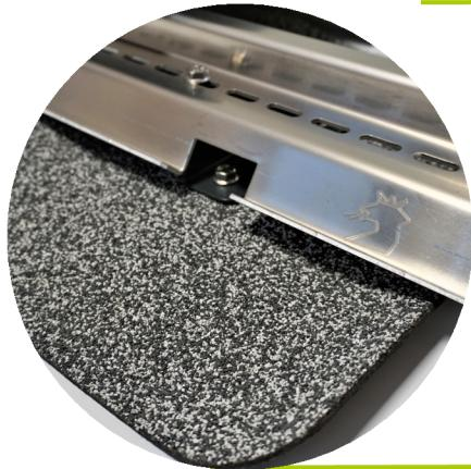
Der GSF Schneehalter ist für die sichere Befestigung der dazugehörigen Schneeschutzschiene. Diese besitzt vorgefertigte Eiskrallen, welche so konzipiert sind, dass nie Druckstellen auf das darunterliegende Folienmaterial erzeugt wird.
