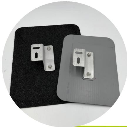
Der GSF PV - Halter UNI sorgt für die sichere und dauerhafte Befestigung von allen herkömmlichen PV - Schienen. Der große Vorteil hier ist die Z - förmige Biegung des Halters. Diese sorgt dafür, dass man die Modultrageschiene direkt an den dafür vorgesehenen Langlöchern am Halter befestigen kann. Dadurch werden keine zusätzlichen Konstruktionswinkel benötigt und wirkt sich somit kostengünstiger aus.
