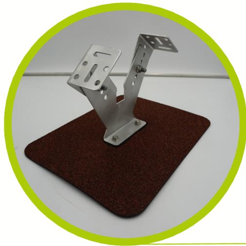
Des weiteren gibt es den EASY mit zwei verschiedenen Grundplatten N oder WD (Warmdach). Somit kann Steirer-Blech auch auf die verschiedensten Dachaufbauten eine sichere Befestigung garantieren. Die Erneuerung an diesem Artikel ist, dass der Halter aus gelenkigen Oberteilen besteht und somit in der Höhe sowie auch in der Modulneigung flexibel ist.
